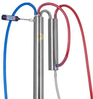
Залейте в перегонный куб спирт-сырец (не более 2/3 от его объема) и произведите сборку оборудования согласно разделу «Порядок сборки» - перегонка с колонной.
