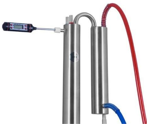
Залейте брагу в перегонный куб (не более 2/3 от его объема), стараясь исключить попадания дрожжевого осадка, и активно помешайте ее в кубе, проведя дегазацию - удаление излишков углекислого газа из браги. Затем соберите оборудование согласно разделу «Порядок сборки» - простая дистилляция.
